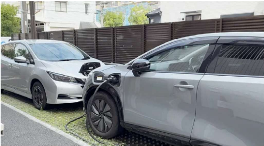
EV車両から給電の様子
