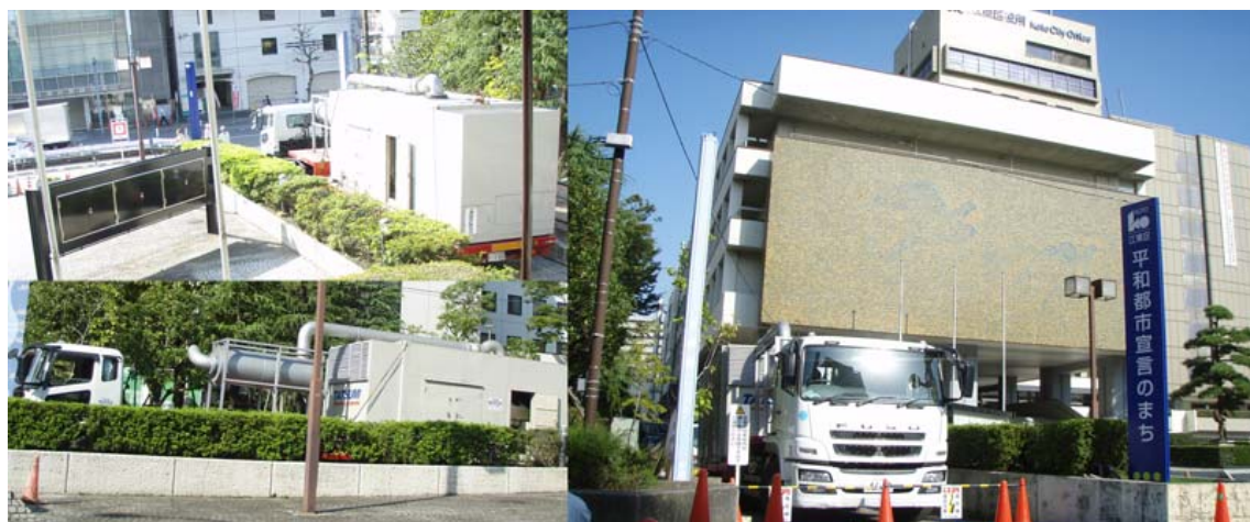
可搬型ディーゼル発電機 6.6kV 1,000kVA 電源供給実施中
